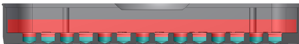
Figuur 12.3 De kweekputjes zijn afgedekt met een minerale olielaag en het deksel wordt erop gedaan
